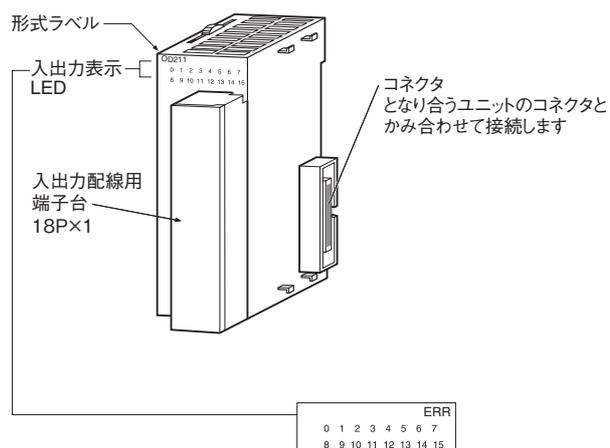
注. 形CJ1W-OD202、形CJ1W-OD204、形CJ1W-OD212のみERR LED（負荷短絡時アラーム表示LED）表示あり
